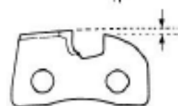
Calibre de adâncime standard 0.64 mm
