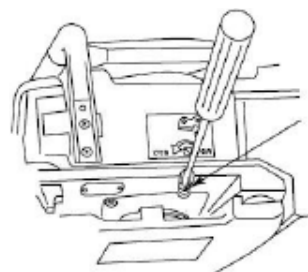
Chain oil flow adjusting = Reglarea debitului de ulei al lanțului
